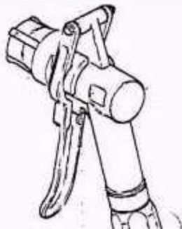
Figura 3 b: ESQUEMA BASICO DEL PICO DEL DISPENSER PARA G.L.P.A.
